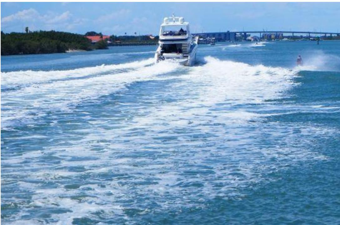
Avec quelques centaines de kilowatts supplémentaires, la coque va déjauger, le navire accélérer franchement et il déplacera moins d'eau.
