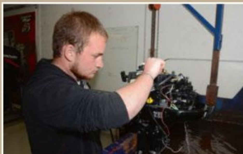
3 ▲ Quand le réglage de la vis de richesse est convenable, n'y touchez plus et peaufinez le réglage du ralenti (vis avec le ressort), moteur embrayé, afin qu'il ne cale pas.
