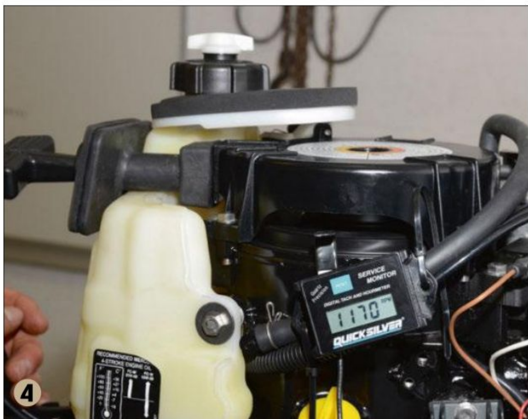
1 ▲ Après avoir fait chauffer le moteur pendant une dizaine de minutes, on règle d'abord le ralenti avec la vis dédiée (celle avec un ressort), jusqu'à obtenir un régime d'environ 1 500 tr/mn.
