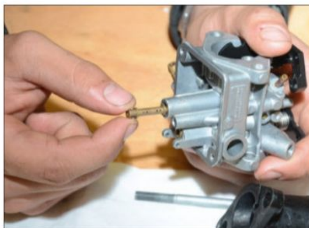
▲ Remontez l'ensemble des éléments puis remettez le carburateur en place.
