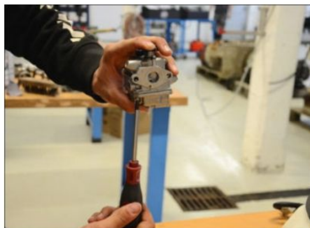
▲ Dévissez la cuve en maintenant le carburateur à la verticale.
