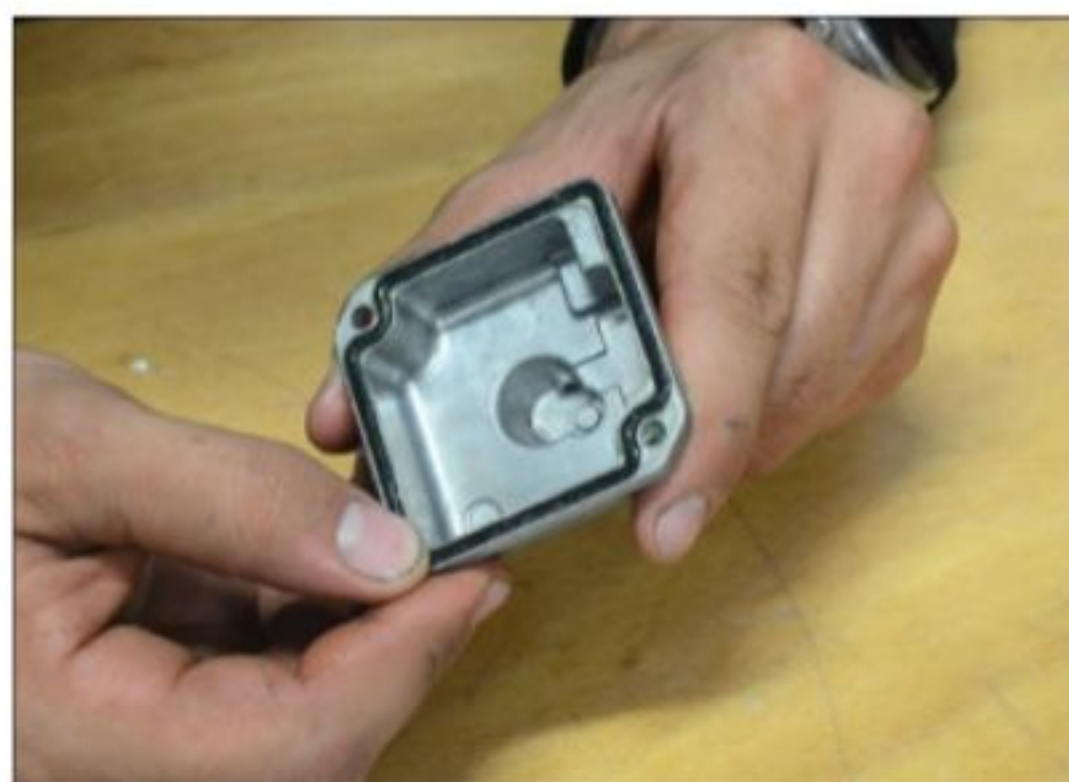
▲ Graissez l'encoche de la cuve, replacez le joint et revissez la cuve.
