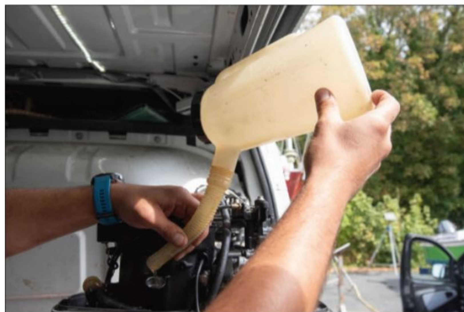
▲ Faites le plein d'huile (type et quantité préconisés par le fabricant).
