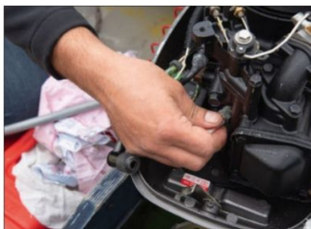
▲ Démontez ensuite la bougie (c'est par cet orifice que l'eau va pouvoir sortir).
