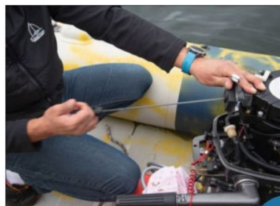
▲ Actionnez plusieurs fois le lanceur pour évacuer l'eau piégée dans les cylindres.
