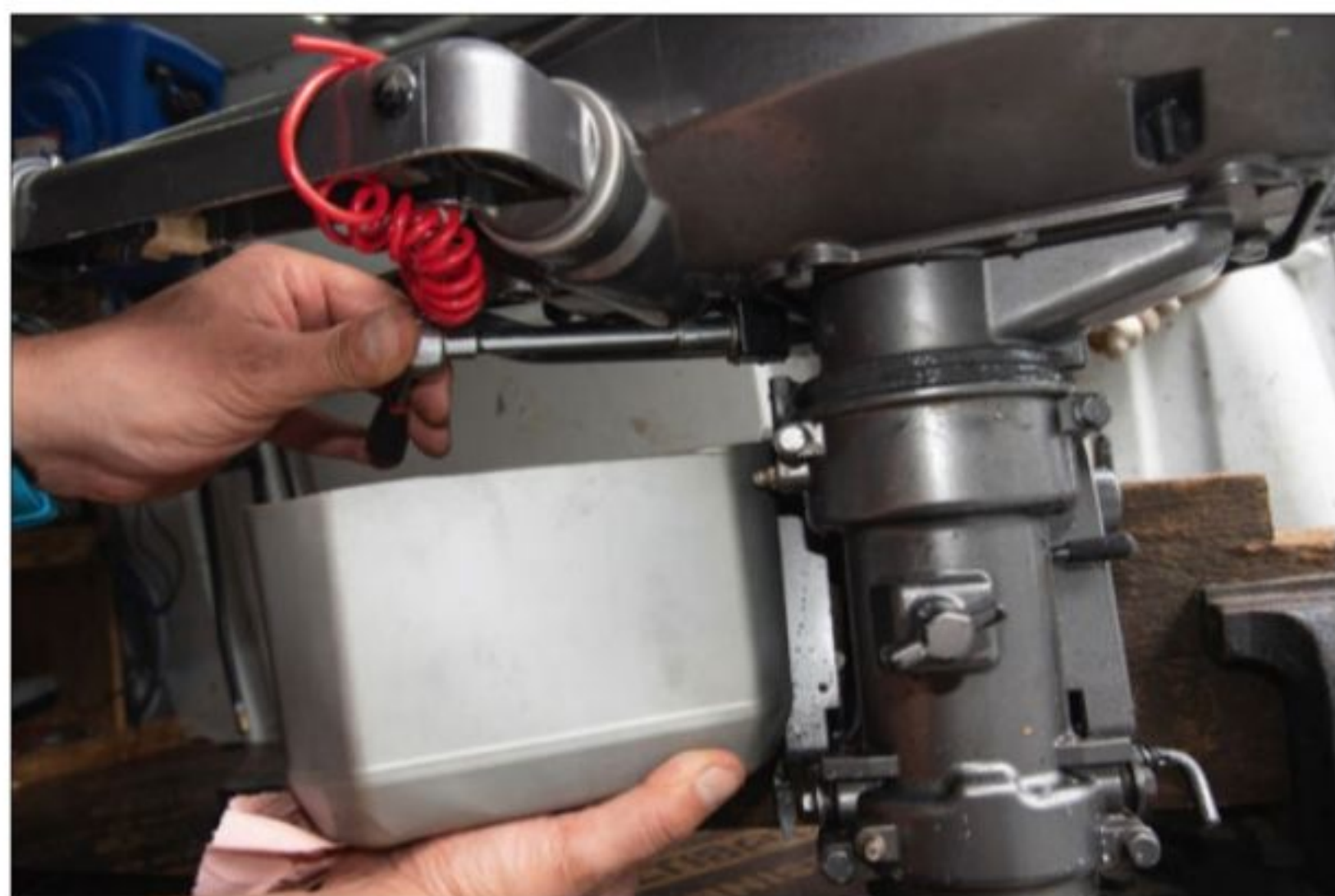
▲ Vidangez l'huile du moteur en dévissant la vis de vidange.
