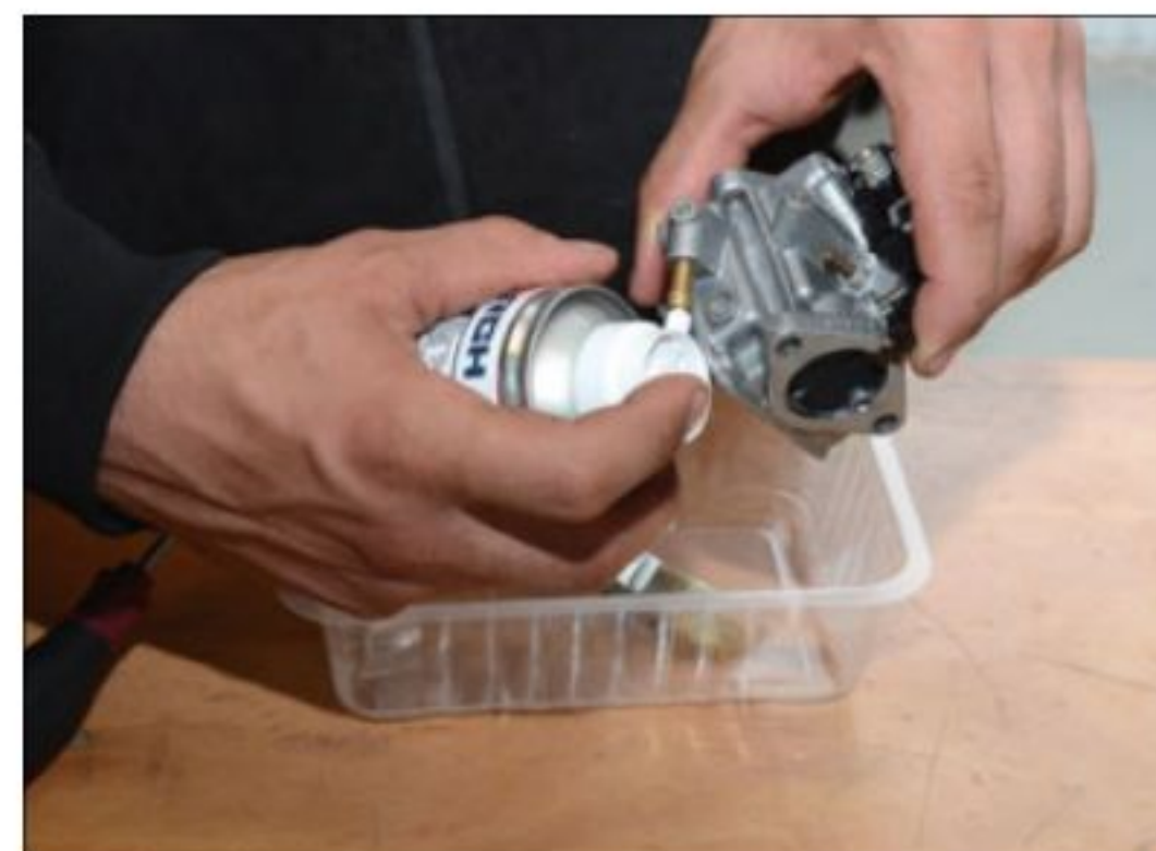
▲ Nettoyez minutieusement l'ensemble du carburateur avec un aérosol spécial.
