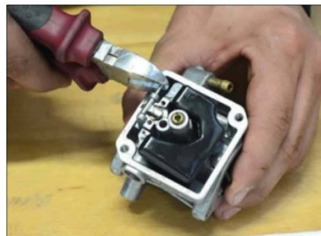
▲ Déposez le flotteur en retirant le petit axe métallique (pièce noire) et son pointeau.
