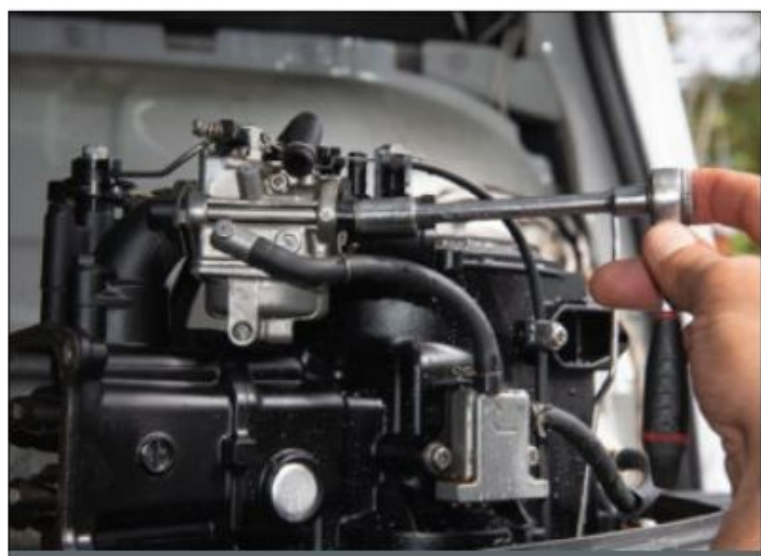
▲ Démontez le carburateur et prévoyez de l'ouvrir dans un endroit propre.
