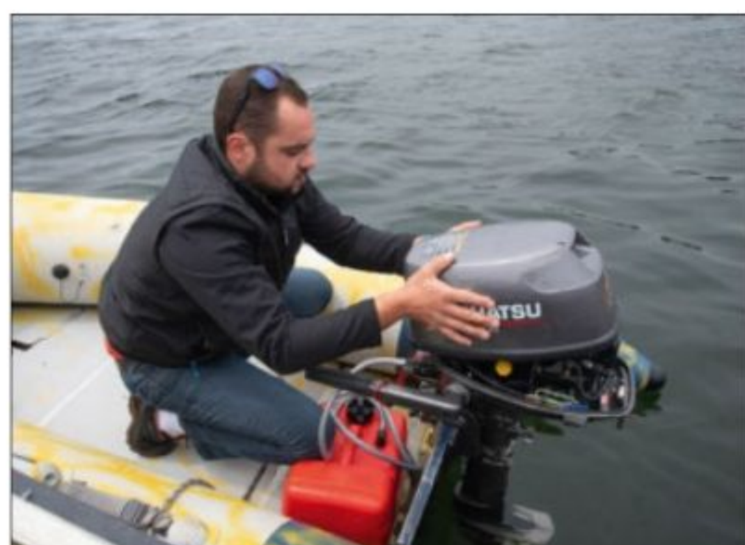
▲ Enlevez le capot et rincez la tête motrice en insistant sous le volant moteur.
