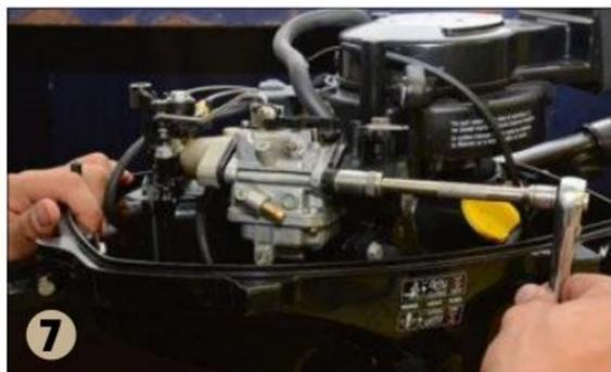
**7** ▲ Vous pouvez maintenant retirer les deux grandes vis horizontales qui permettent de fixer le carburateur au moteur hors bord.
