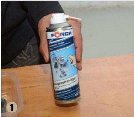
**1** ▲ Les pros sont équipés d'un bac à ultrasons pour nettoyer le carburateur. Contentez-vous d'un nettoyant aérosol spécial carburateur.
