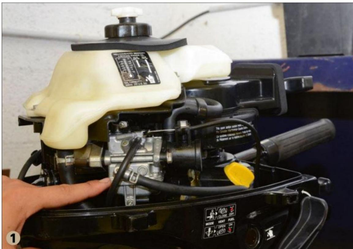
▲ Branché au réservoir et connecté à l'admission d'air, le carburateur gère le mélange air/essence qu'il envoie ensuite vers le moteur. Le carburateur doit être contrôlé tous les ans. Il est en effet très rare de ne pas y trouver des dépôts, souvent de l'eau et du sable.
