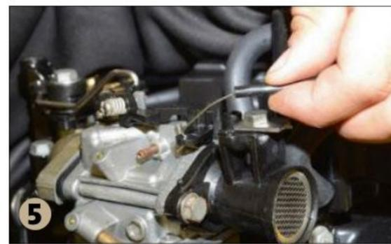
**5** ▲ Le câble du starter, gainé sur quasiment toute sa longueur, doit également être débranché pour pouvoir démonter le carburateur.
