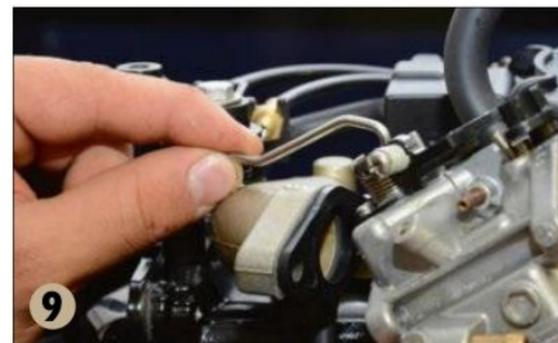
**9** ▲ Le carburateur n'est pas encore tout à fait libre. Il est retenu par un dernier élément de tringlerie : le câble d'accélération du moteur.
