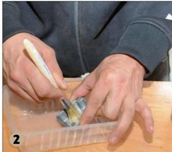
**2** ▲ Retirez soigneusement les impuretés de la cuve au pinceau. A défaut d'un produit adapté, vous pouvez utiliser de l'essence propre.
