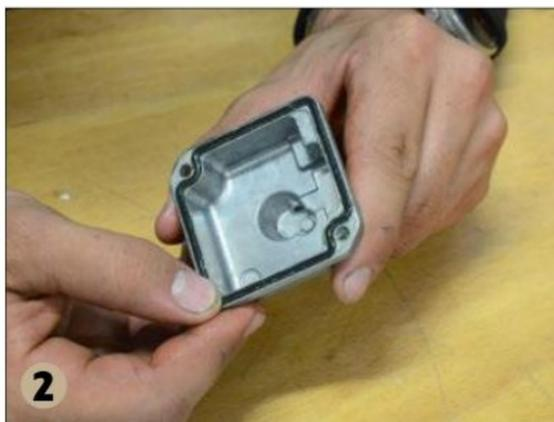
**2** ▲ Remplacez le joint de la cuve, nettoyez le surplus de graisse avec un chiffon propre, puis revissez la cuve sous le carburateur.
