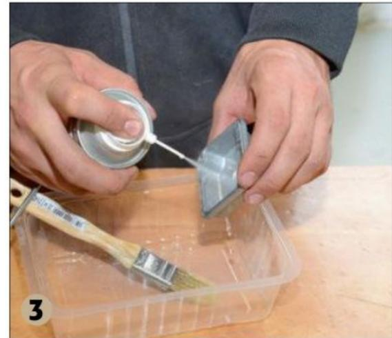
**3** ▲ Aspergez chaque élément du carburateur avec l'aérosol. Ne lésinez pas sur le nettoyage, toutes les pièces doivent être impeccables.
