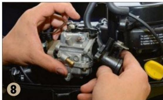
**8** ▲ Les deux vis maintiennent également l'admission d'air (pièce en plastique) contre le carburateur. Cette pièce est aussi déposée.
