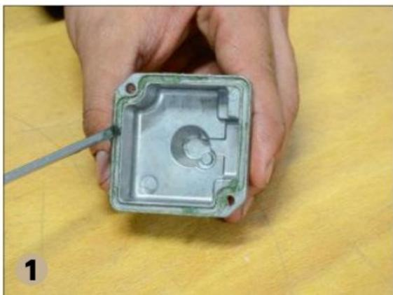
**1** ▲ Juste après avoir nettoyé le joint et la cuve, garnissez l'encoche avec de la graisse mécanique qui a l'avantage de stabiliser le caoutchouc.
